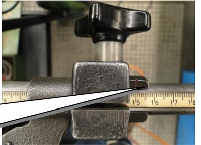
Spannhebel lösen und passende Dimension einstellen
