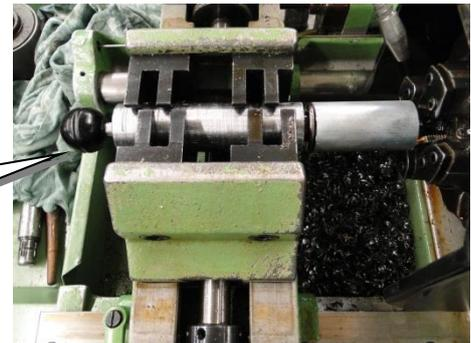
Bei kürzeren Rohren, ist der Nippelhalter zu verwenden.
