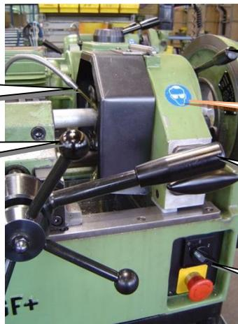
Spannhebel um Backen zu spannen, nach jedem Gewinde
