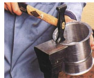
Der Schweifhammer hat zwei Bahnen mit unterschiedlichen Rundungen.
